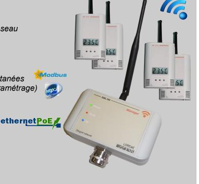
Le SML160 est un récepteur sans fil avec une liaison Ethernet, le produit concentre toutes les mesures émises par les transmetteurs radio, et les met à disposition par le biais d'un protocole de communication standard (Modbus-TCP) sur la liaison Ethernet.
