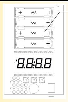
Remplacement des 4 piles AAA, après avoir déclipsé la carte du boitier. Attention au passage du câble d'antenne, lors de la remise en place de la carte dans le boitier.
