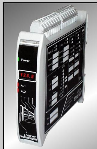
Le DNL35-MLi permet la conversion d'un signal analogiques en sorties contacts libre de potentiel modulées en largeur d'impulsion (rapport cyclique proportionnel au signal d'entrée)
